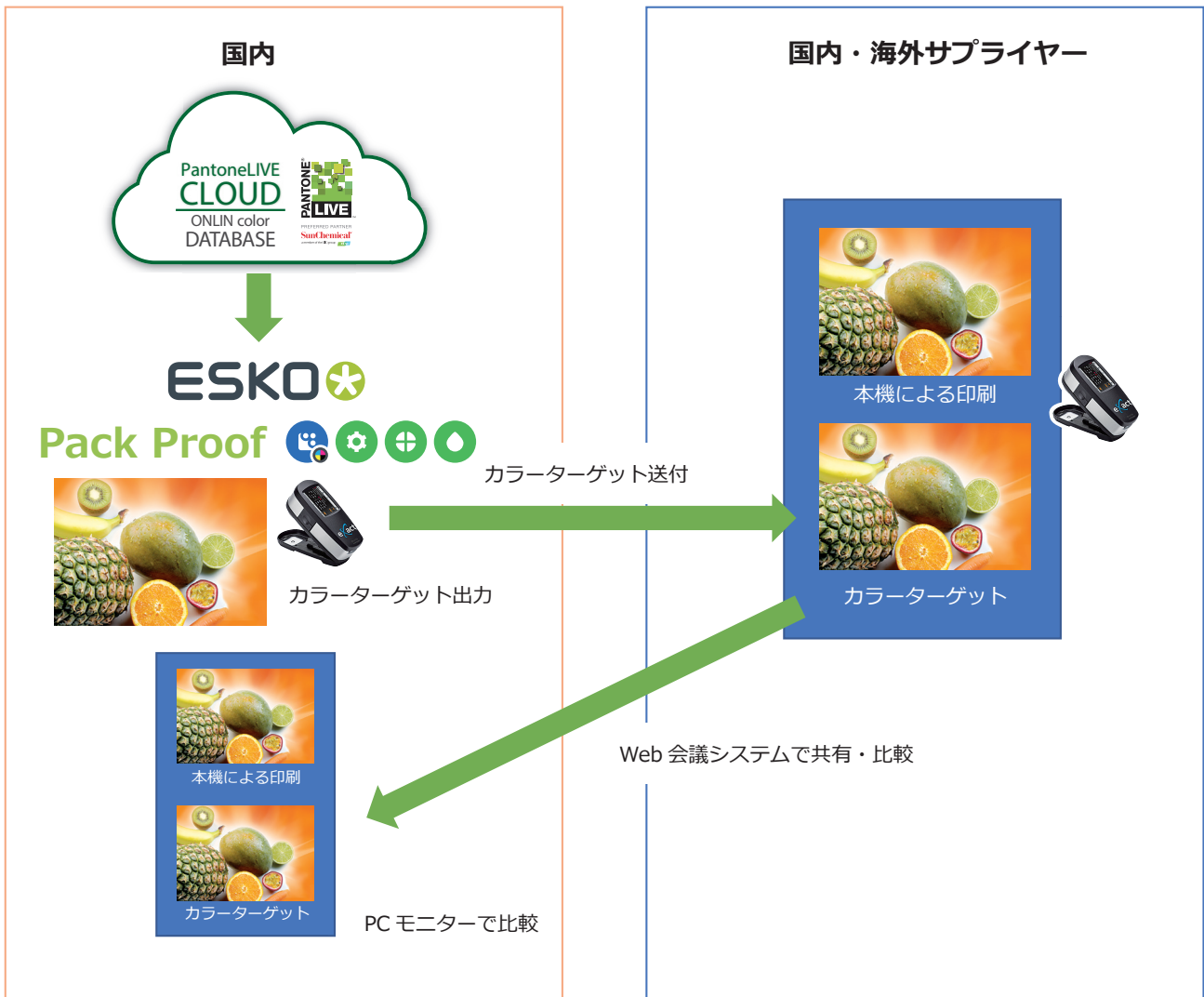
Pack ProofとPANTONE LIVE、eXactを利用したリモート立ち合いのスキーム
